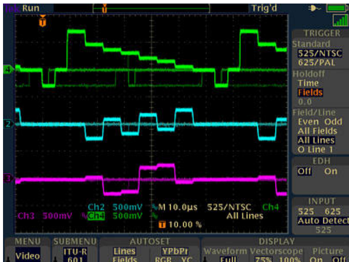
使用 TDS3SDI 601 系列数字视频模块，跟踪和识别 ITU-R BT.601 视频信号。
