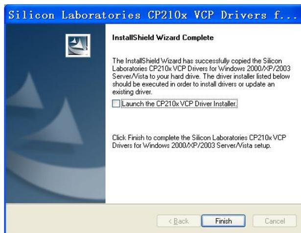
使用 USB 线缆将 GM8012 与电脑连接，启动 GM8012，电脑会提示自动安装 USB 硬件，安装完毕后，打开 Windows 的设备管理器，在“端口(COM 和 LPT)”处可查看新增加的端口号。
